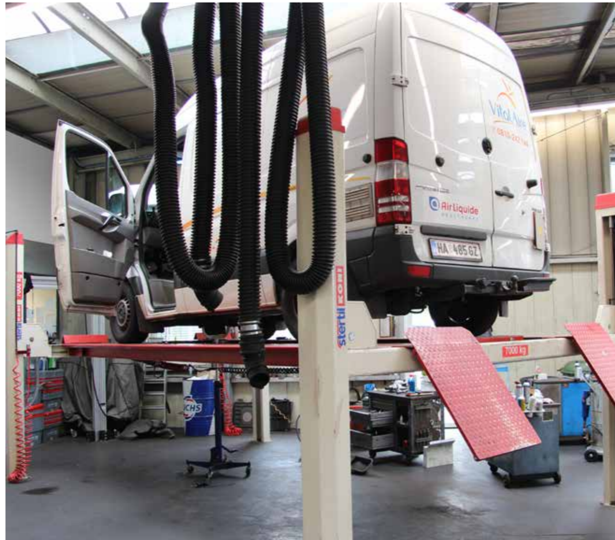
Im Einsatz bewährt hat sich beim Salzburger Unternehmen auch eine 7-Tonnen-Viersäulen-Hebebühne von Stertil-Koni
